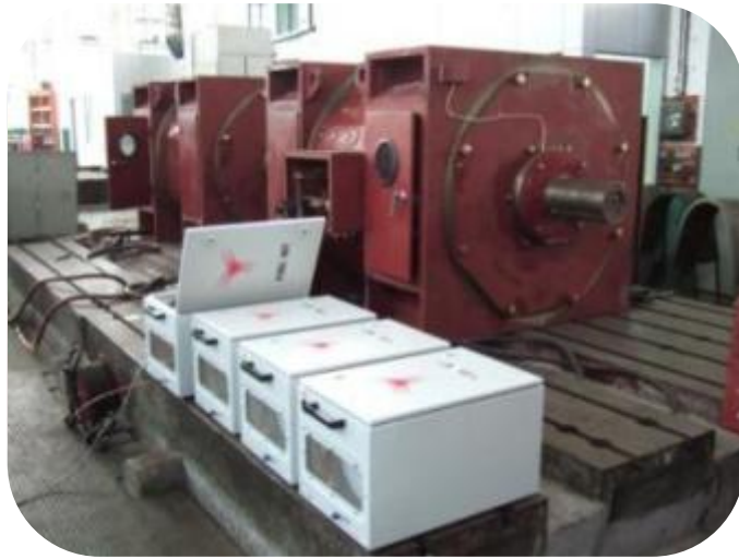
KiloSense 为某电机公司提供的 1000A 大功率电机类产品传导骚扰测试系统(CE102)
