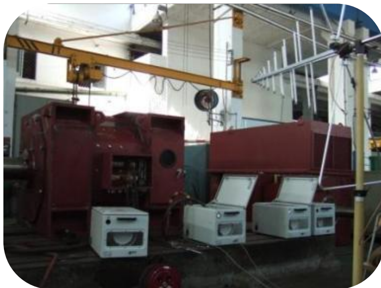
KiloSense 为某电机公司提供的 1000A 大功率电机类产品辐射骚扰测试系统 (RE102)
